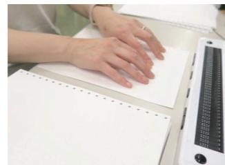
PCでメモする場合は、キーボードで点字を入力。「点字ディスプレイ」に表示された凹凸を指で読みます。
