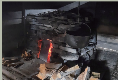
上・スモークサウナのストーブの石を温めるために、薪を燃やす。下・西部に残る大型のスモークサウナのストーブ。1500kgを超える石が積まれている。
